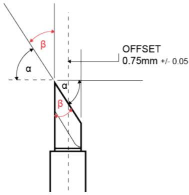
2 méthodes de mesure de l'angle de la lame :
